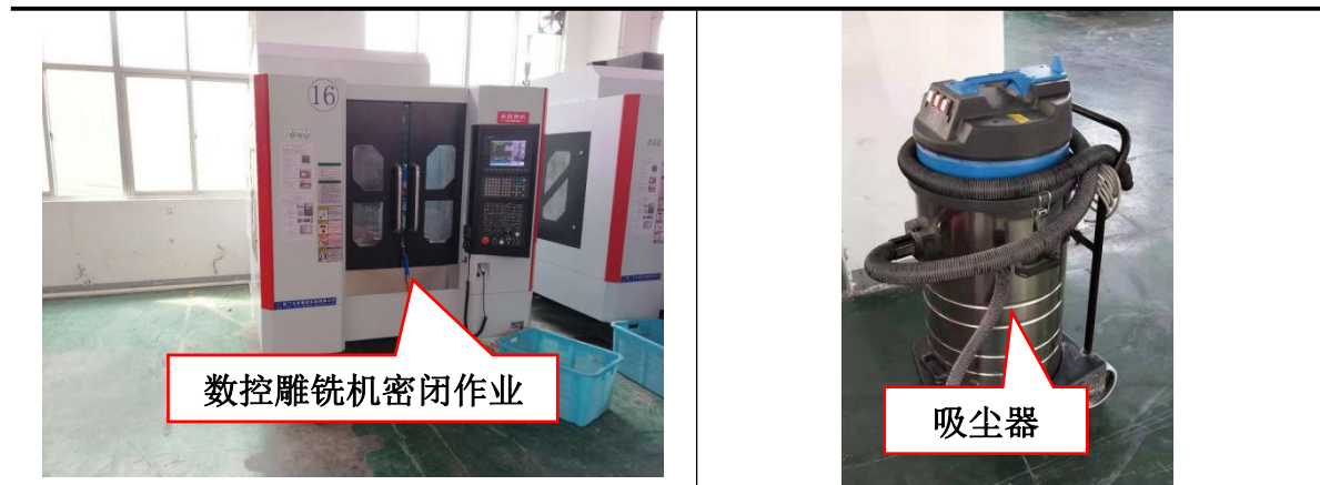
图 3.1.1 扩建项目数控雕铣机密闭设备
